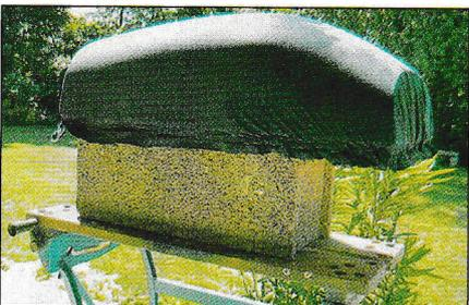
La forme, ou master, a été recouverte d'un tissu fin (genre suédine ou autre) qui permet au plastique chaud de glisser facilement lors du thermoformage, sans se rayer.
