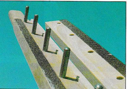
Gros plan sur l'une des deux pinces nécessaires pour maintenir la feuille à thermoformer. Ses "mâchoires" sont munies d'une bande de papier de verre pour éviter que le plastique ne glisse durant la phase d'emboutissage.
